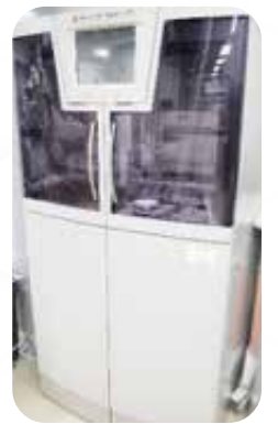
図1：FFPE ブロック 図2：連続迅速自動固定包埋装置
